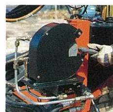
車載型ビット研磨装置 穿孔以外の時間を短縮し 施工の効率を向上
