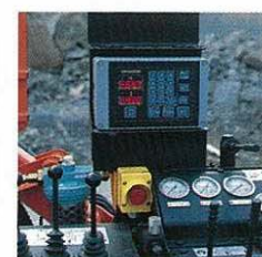
TIM 穿孔角度制御装置 穿孔の正確性を高め 爆薬の使用量を削減
